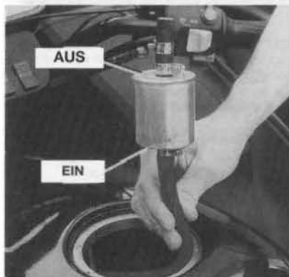
FOTO 8: Sentido de montaje del filtro de gasolina (foto RMT) EIN: ENTRADA, AUS: SALIDA
