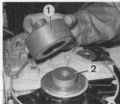
FOTO 65: Colocación de una junta de apoyo trasero motor con el útil BMW, compuesto de un empujador (1) y de un centrador (2) (foto RMT)
