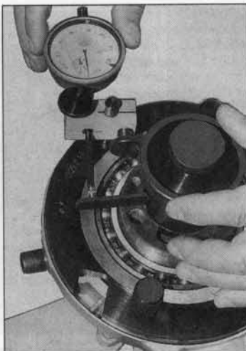
FOTO 90: Montaje del conjunto de útiles de control del juego entredientes (foto RMT)
