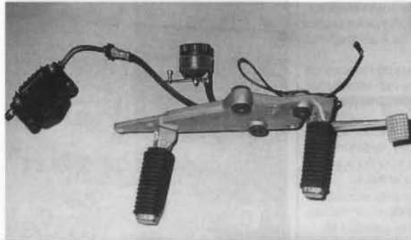
FOTO 72: Sistema de frenos trasero, placa y reposapiés derecho se desmontan en conjunto (foto RMT)
