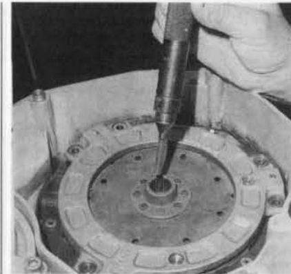
FOTO 61: Centrado del disco de embrague.
