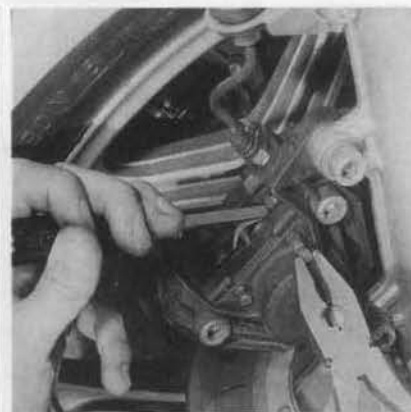
FOTO 28: Extracción de ejes de las pastillas de freno (foto RMT)
