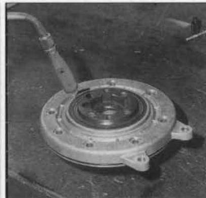
FOTO 88: Para separar la corona calentar la tapa (foto RMT)
