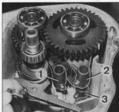
FOTO 84: Horquillas de selección 1. Horquilla del piñón conducido del eje intermediario -2 y 3. Horquillas de los piñones conducidos del eje de salida (foto RMT)
