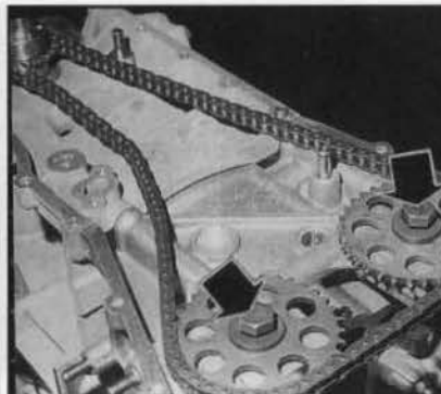
FOTO 43: Para permitir el paso de la cadena al ensamblarla no enroscar completamente los tornillos de los piñones (foto RMT)
