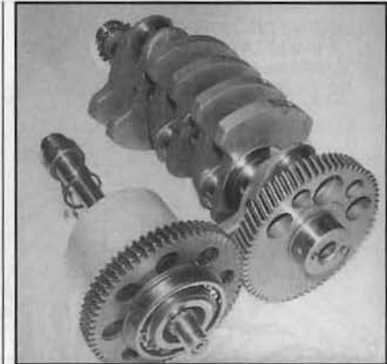
Una de las numerosas características de este motor K 100 es que el eje motor es arrastrado por el ? trasero dentado del cigüeñal y que contiene un amortiguador de par de mayores dimensiones (Foto RMT)
