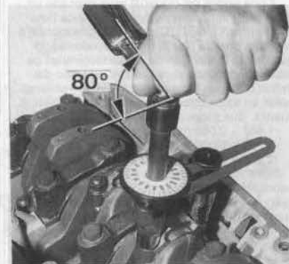
FOTO 54: Apriete angular de las tuercas de cabezas de biela con el dispositivo BMW (foto RMT)
