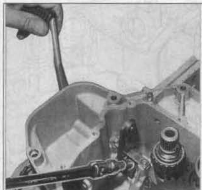
FOTO 77: Retirada del tornillo de fijación del brazo giratorio en el eje de selección (foto RMT)
