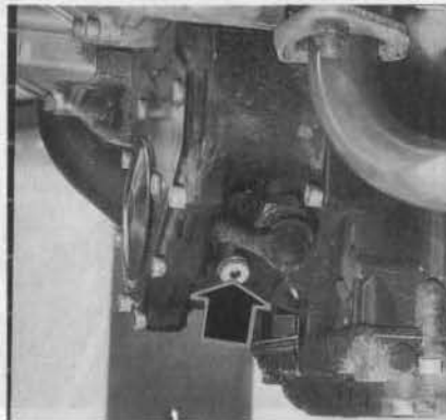
FOTO 5 : Tornillo de vaciado del circuito de refrigeración en la bomba de agua (foto RMT)
