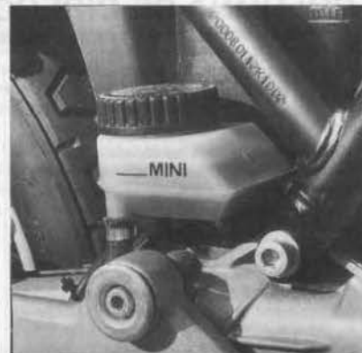
FOTO 26: Nivel de líquido en el depósito del cilindro maestro del freno delantero (foto RMT)
