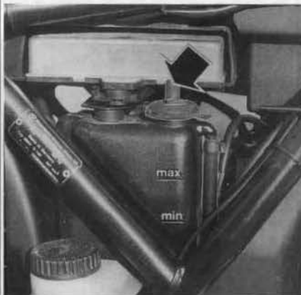
FOTO 3 : Nivel de líquido de refrigeración dentro del vaso de expansión con tapón para completar (foto RMT)
