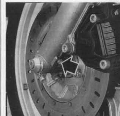
FOTO 24: Tornillo de vaciado de un brazo de horquilla delantero (foto RMT)
