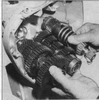
FOTO 80: Desmontaje simultáneo de los tres ejes de caja (foto RMT)
