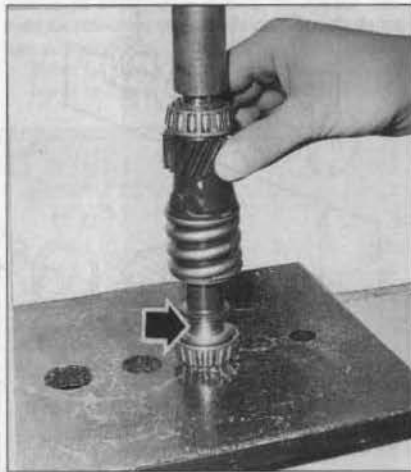
FOTO 82: Colocación del rodamiento delantero del eje de entrada de caja intercalando previamente las arandelas de espesor (flecha) (foto RMT)
