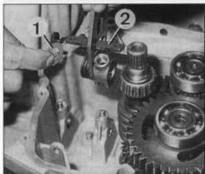
FOTO 83: Ensamblado del brazo giratorio sin olvidar la arandela (1) del eje de selección y la varilla de anclaje (2) del muelle de retorno (foto RMT).
