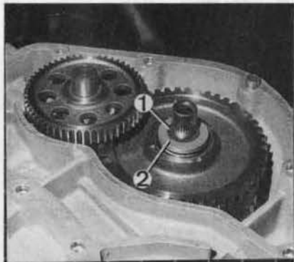
FOTO 68: Junta tórica (1) y arandela (2) del eje de la rueda libre de arranque (foto RMT).
