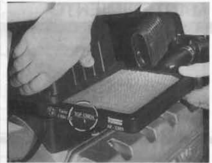
FOTO 7 : Sentido de montaje del elemento filtrante con su flecha TOP indicando hacia arriba (foto RMT)
