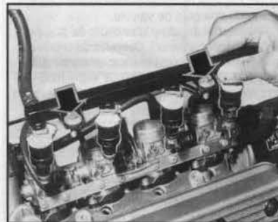
FOTO 46: Los dos tornillos de fijación de la ramba de inyectores (foto RMT)
