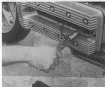
FOTO 15: Acceso a las bujías tras desmontar la placa y extraer con unos alicates los capuchones.
