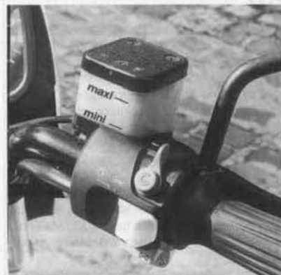
FOTO 27: Nivel de líquido en el depósito del cilindro maestro del freno trasero (foto RMT)
