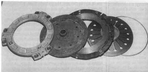
Composición del mecanismo de embrague (Foto RMT)
