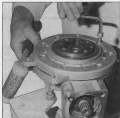
FOTO 86: Desmontaje de la tapa del par cónico golpeando con un martillo (foto RMT)
