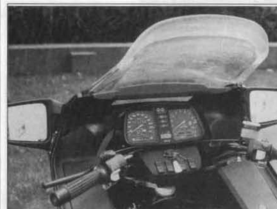
El carenado de la K 100 RT resguarda en toda su amplitud el cuadro de instrumentos y viene con pequeños maleteros con cerradura (foto RMT)
