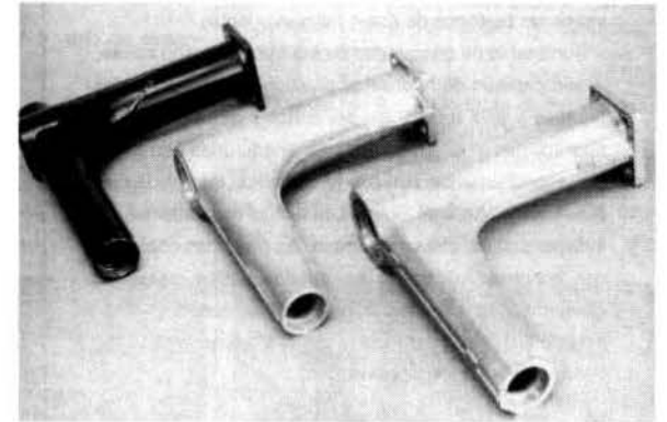
Evolución del proyecto de brazo oscilante trasero. De arriba abajo: brazo oscilante de acero tipo R 80 G/S; brazo oscilante de aleación ligera no estriado; brazo oscilante de aleación ligera muy estriado elegido para la serie.
