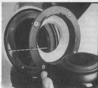
FOTO 9: Ensamblado del tapón del depósito de gasolina haciendo corresponder su orificio y el corte de la junta con la toma de aire exterior del depósito (foto RMT).
