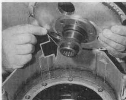
FOTO 63: Ubicación de la arandela de material compuesto (foto RMT)
