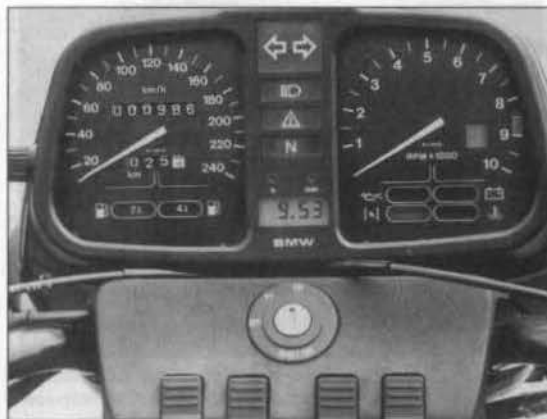
Cuadro de instrumentos muy completo del modelo K 100, aquí con reloj de a bordo opcional.
