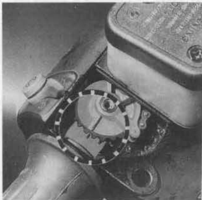
FOTO 13 bis: Marcas para hacer corresponder durante el montaje del tubo de retorno el ángulo del mecanismo de ? del cable en el puño giratorio (foto RMT)
