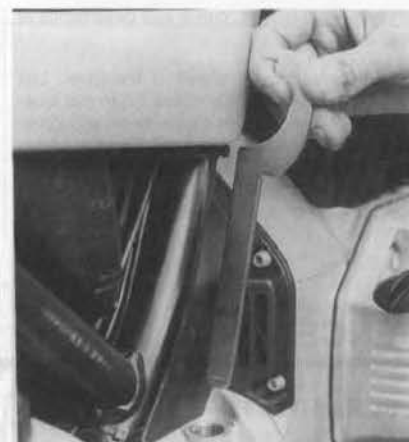
FOTO 20: Control del nivel de aceite de caja con el mango de la palanca de reglaje del amortiguador trasero (foto RMT).
