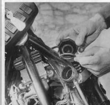
FOTO 4 : Tapón de llenado del circuito de refrigeración y su junta (foto RMT)
