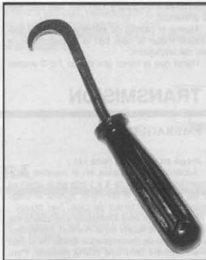
FOTO 16: Palanca BMW para el hundimiento de los empujadores (foto RMT)
