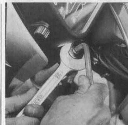
FOTO 23: Afloje del tornillo de llenado de aceite de un brazo de horquilla delantero (foto RMT)
