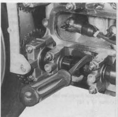
FOTO 18: Hundimiento del empujador con la palanca BMW (foto RMT)
